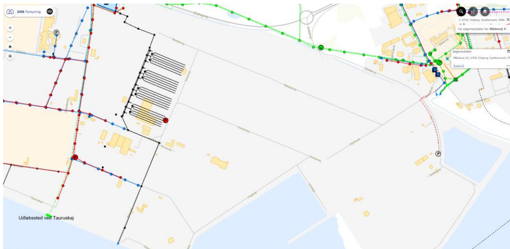
Fig 5. Udledningssted ved Tauruskaj for udledning af rensset spildevand fra rensningsanlæg Øst.
